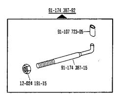
Graisseur de fil zur-pour Lubricador del hilo for-para Pfaff 487/489-706/81; -706/83
